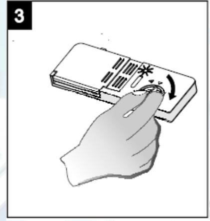
1. Чтобы открыть резервуар, прокрутите крышку до положения «открыто» (стрелка влево) и снимите крышку.
