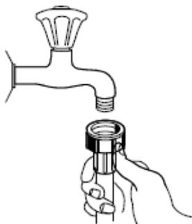
Подключите шланг для подачи холодной воды к соединительному колену с резьбой  $\frac{3}{4}$  дюйма; при этом следите за прочностью соединения. Если трубы новые или не использовались в течение длительного времени, дайте воде стечь, пока она не станет прозрачной. Данная мера необходима для предотвращения засорения канала для подачи воды и повреждения прибора.
