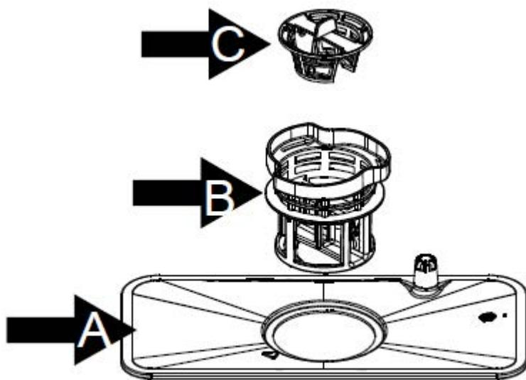
Система фильтров состоит из фильтра грубой очистки, плоского главного фильтра и микрофильтра тонкой очистки.
