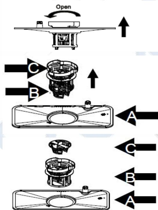
Шаг 1: прокрутите фильтр (А,В и С) против часовой стрелки, а затем выньте его.
